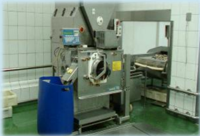
Separator B-603 wykorzystany w próbach do oddzielania mięsa od kręgosłupów łososi
