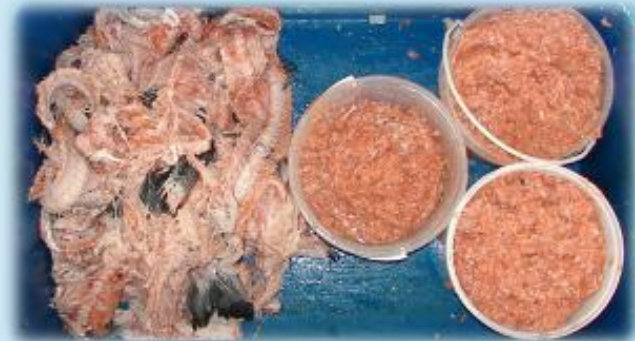
Kręgosłupy i oddzielone mięso po mechanicznej separacji na urządzeniu B-603
