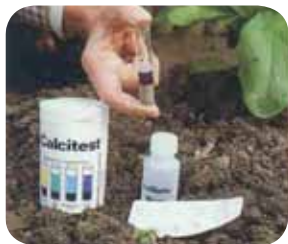
Sl. 4: Nedostatak pojedinih elemenata često je uzrok nepovoljne kiselosti zemljišta, pa je potrebno redovno raditi jednostavne poljske analize pomoću kalcitesta.
